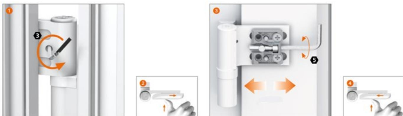
**Stranové seřízení** – Vyvarujte se osovému napětí na pantech vlivem nerovnoměrného otáčení šrouby, šrouby otáčejte postupně na všech pantech v požadovaném směru.
