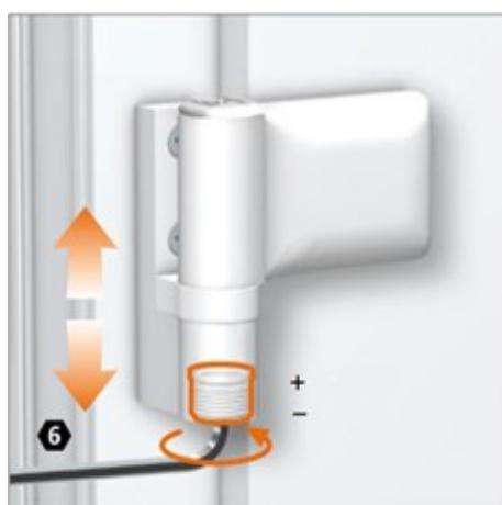
**Seřízení výšky** – Výšku je nutno nastavit na všech pantech stejně kvůli rozložení hmotnosti křídla.
