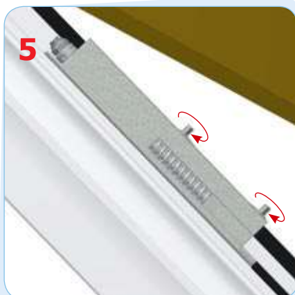
Regulace síly otevírání a polohy zajištění okna (max. 1 otočení najednou)
