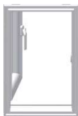
Otevřená zajištěná poloha umožňuje otevření křídla v úhlu cca 90°
