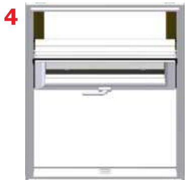
Otevřená zajištěná poloha umožňuje otevřít křídlo v úhlu cca 45°
