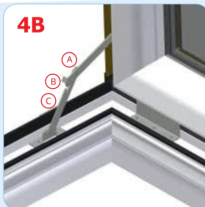
Pokud chceme křídlo nastavit do otevřené zajištěné polohy, je třeba přesunout část zarážky u křídla A ve kloubu B rámové části zarážky, jako je tomu na obrázku 4C
