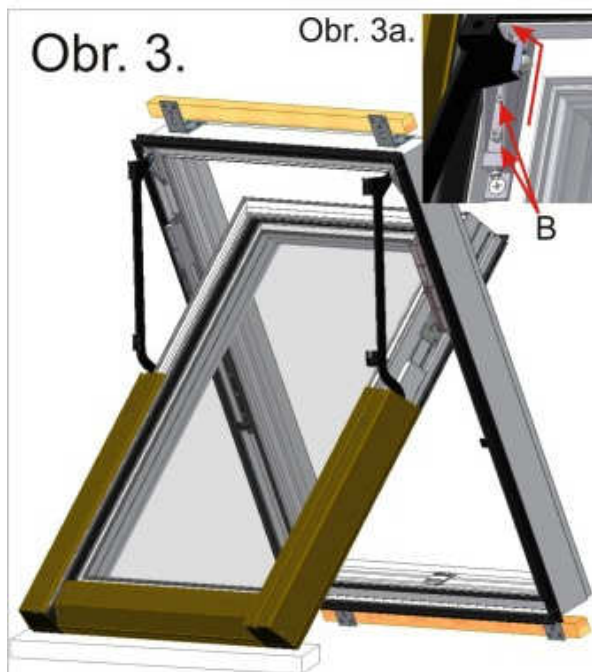
Obr. 3. Po odstranění horní části oplechování povolit zajišťovací šrouby B a rozpojit kování jak je nakresleno na Obr.3a. Toto provést současně na levé i pravé straně. Vyjměte opatrně křídlo a položte ho na čistou a měkkou podložku. Odšroubujte horní a dolní dřevěnou transportní lištu.
