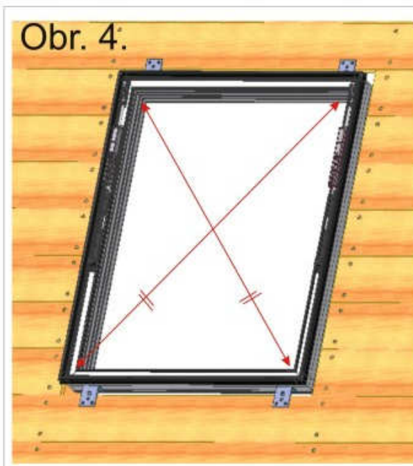
Obr. 4. Připravte otvor pro vložení rámu jak je znázorněno na Obr.4. Upevněte pomocí vrutů rám do latí, vždy po třech vrutech na jeden montážní uhelník. POZOR: je třeba dbát na správné vycentrování a rozteč úhlopříček max. rozdíl 1 mm).
