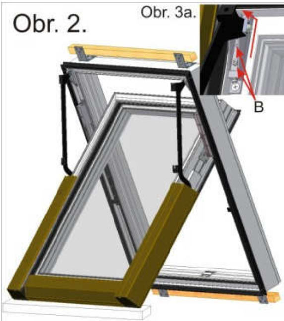
Obr. 2. Obr. 3a. Po odstranění horní části oplechování povolit zajišťovací šrouby B a rozpojit kování jak je nakresleno na Obr.3a. Toto provést současně na levé i pravé straně. Vyjměte opatrně křídlo a položte ho na čistou a měkkou podložku. Odšroubujte horní a dolní dřevěnou transportní lištu.
