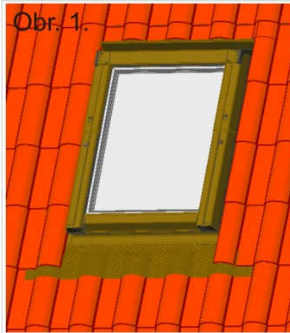
Obr. 1. Střešní okno Skylight Premium zamontované ve střeše s vlnitou střešní krtytinou.
